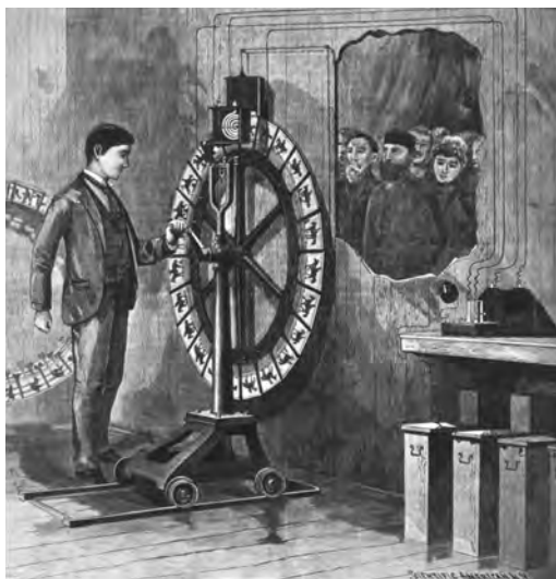
Elektryczny szybkowidz (elektrotachyskop) Ottomara Anschütza z 1887 roku: 23 fazy obrazu oświetlane światłem z rury Geisslera oglądane przez wziernik dawały wrażenie ruchomego obrazu
