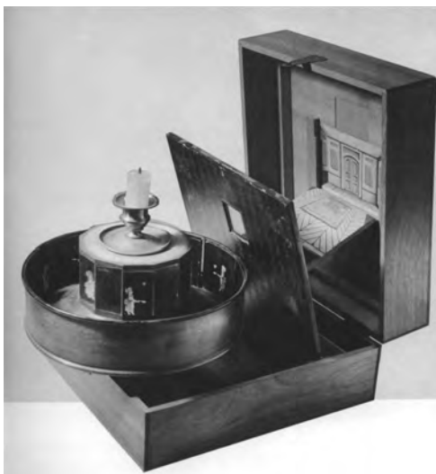
Przenośny praksinoskop teatralny Émile'a Reynauda z drugiej połowy lat 70. XIX wieku – kombinacja zootropu i przenośnej panoramy
