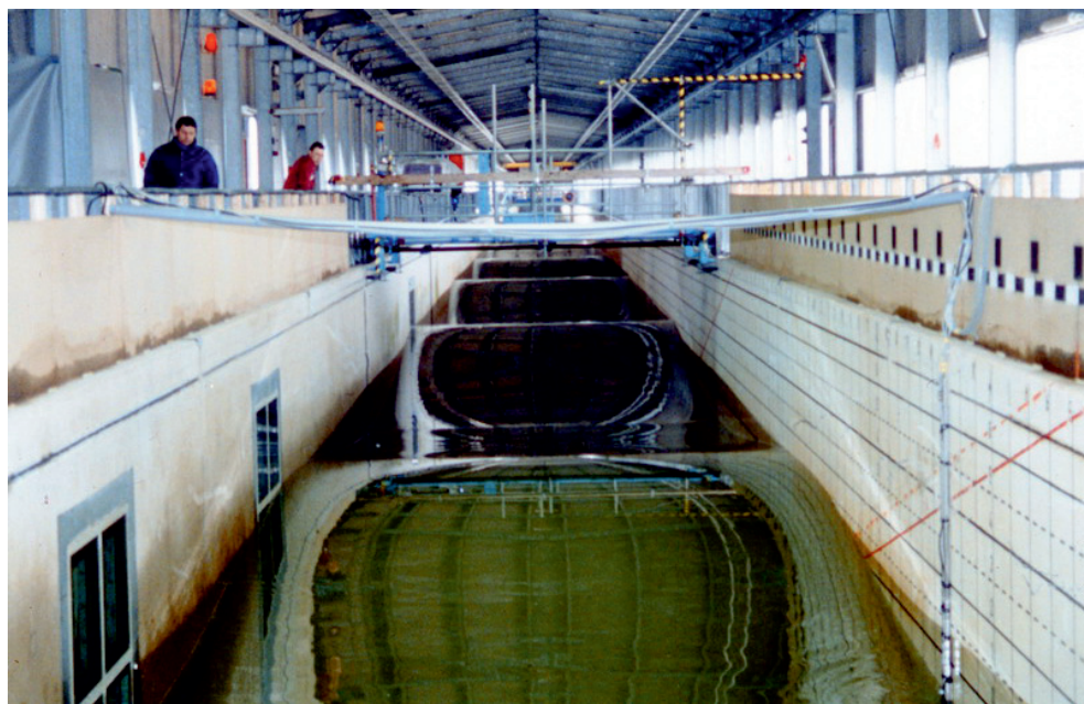
Rys. 2.1. Fala regularna generowana w laboratorium hydraulicznym, tzw. dużym kanale falowym (niem. Grosser Wellen Kanal (GWK)), na Uniwersytecie Leibniza w Hanowerze (Niemcy)
