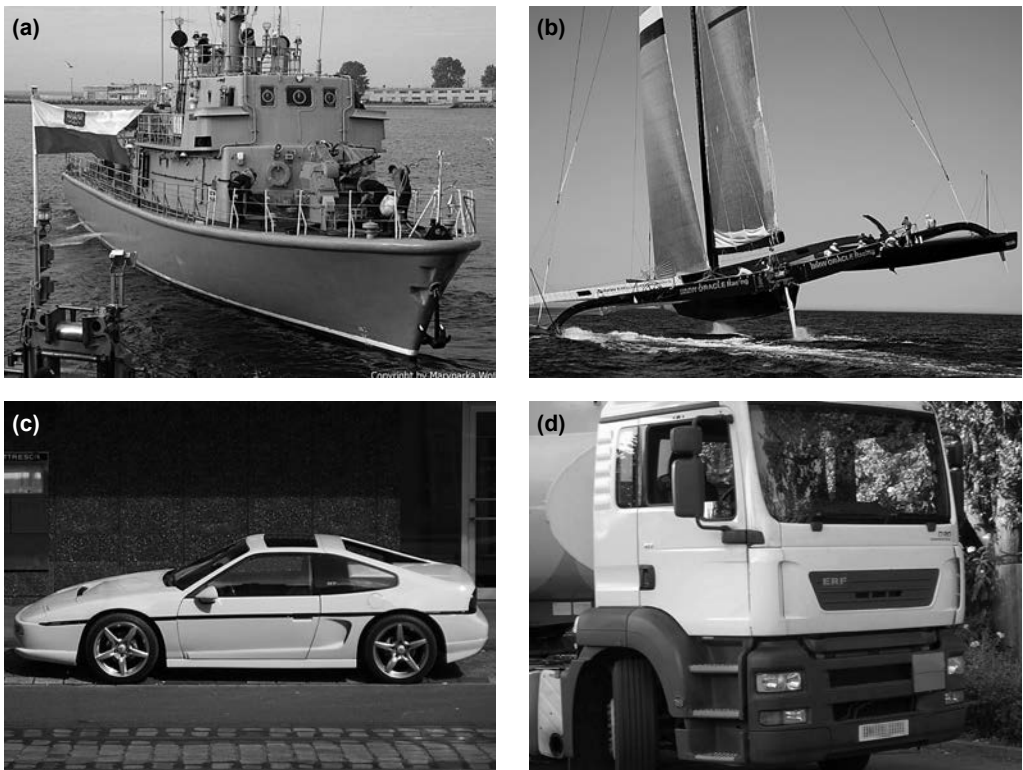
Rys. 1.1. Różne konstrukcje z kompozytów polimerowych: (a) trałowiec Marynarki Wojennej RP, (b) trimaran z kompozytów z włóknem węglowym, (c) Pontiac Fierro z różnego typu kompozytów polimerowych, (d) kabina ciężarówki, (e) wagon kolei ultraszybkiej, (f) lekki samolot, (g) szybowiec, (h) Boeing 787 „Dreamliner”, w którym kompozyty stanowią 50% masy konstrukcji, (i) rakietka tenisowa, (j) rotory elektrowni wiatrowych, (k) kopuła radarowa z laminatów trójkątów sferycznych, (l) zbiorniki nawijane
