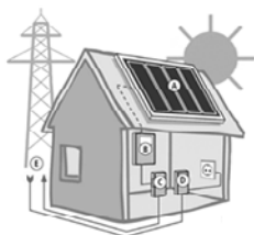
System połączony z siecią
