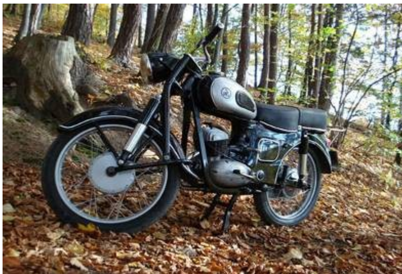
42. Motocykle SHL M11 odznaczały się nowoczesnym przednim zawieszeniem z wahaczem pchanym i dwoma amortyzatorami
